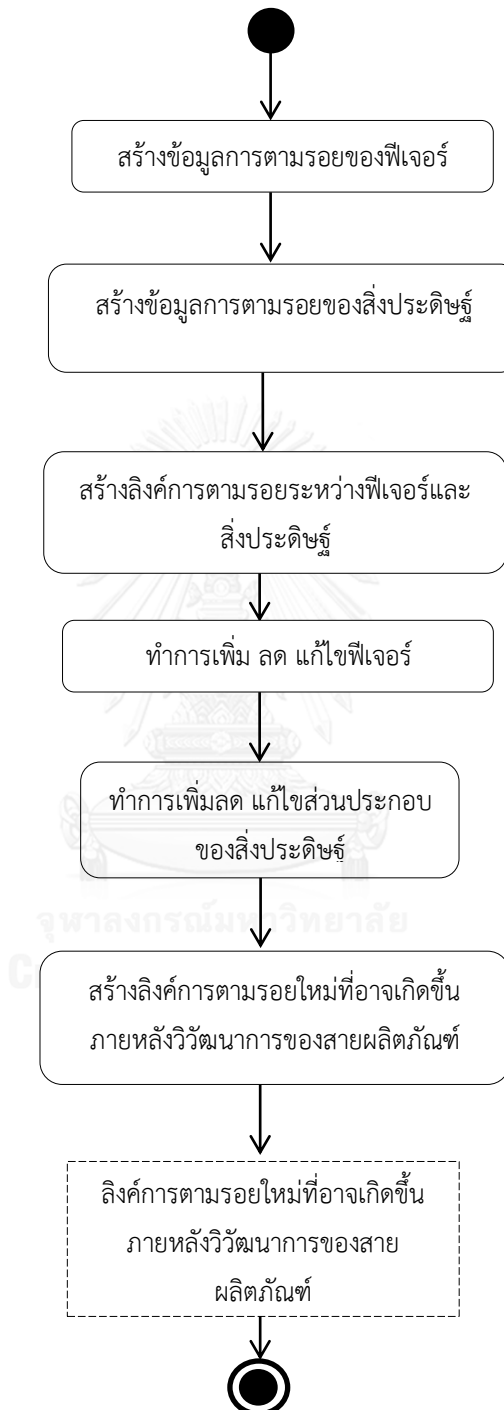
รูปที่ 3.3 ขั้นตอนของการออกแบบวิธีการตามรอยเชิงพีเจอร์สำหรับวิวัฒนาการสายผลิตภัณฑ์ซอฟต์แวร์โดยใช้เทคนิคเวกเตอร์สเปซโมเดล
