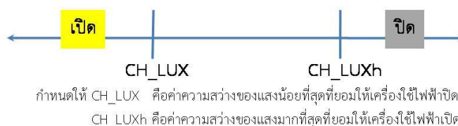
รูปที่ 3-21 เงื่อนไขของการควบคุมอัตโนมัติด้วยเซ็นเซอร์วัดความสว่างของแสง
