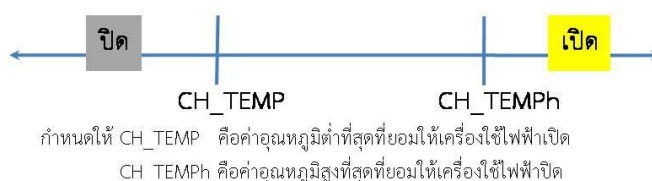
รูปที่ 3-22 เงื่อนไขของการควบคุมอัตโนมัติด้วยเซ็นเซอร์วัดอุณหภูมิ
