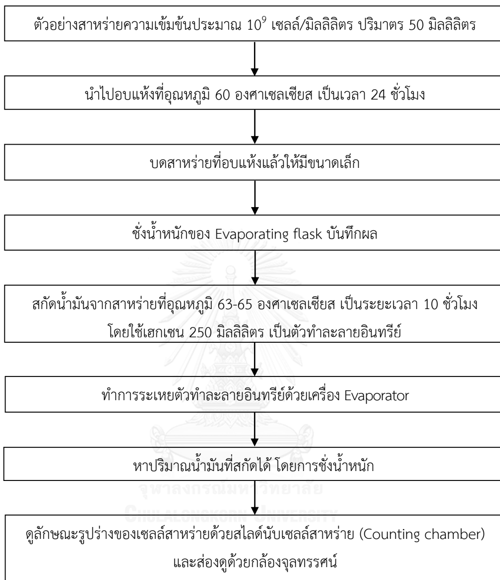
รูปที่ 3.6 การสกัดน้ำมันจากสาหร่ายด้วยวิธี Soxhlet
