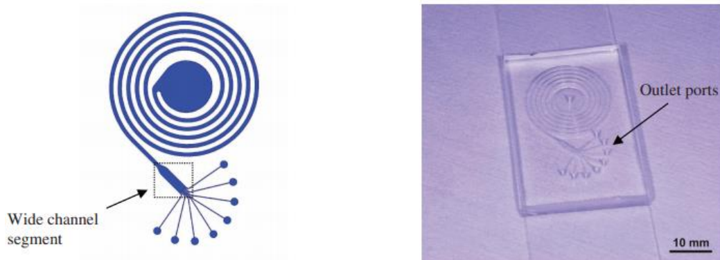
รูปที่ 2.8 อุปกรณ์การคัดแยกด้วยเทคนิคท่อขดรูปเกลียว El Hasni, A., et al. [10]
