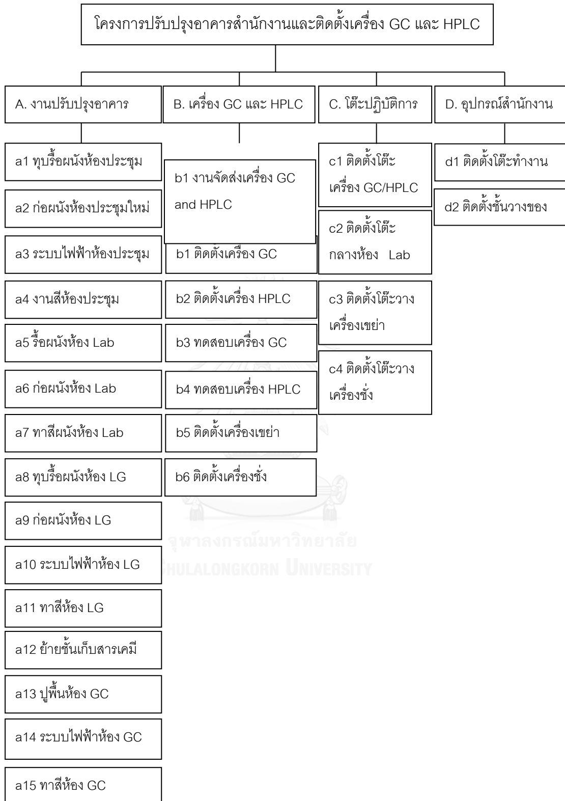
รูปที่ 4.15 การแบ่งโครงสร้างการทำงานของโครงการ (WBS)
