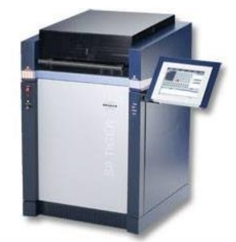
รูปที่ 3.7 เครื่องเอกซเรย์ฟลูออเรสเซนซ์สเปกโตรมิเตอร์ [28]
