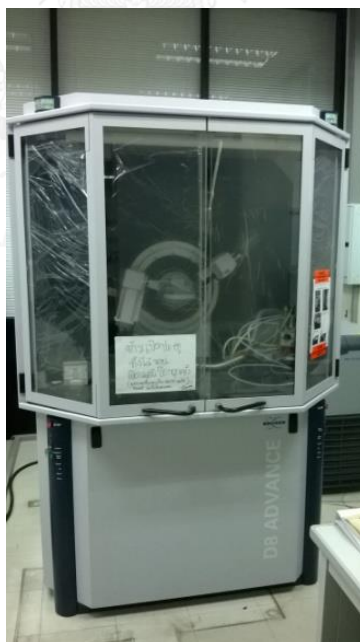
รูปที่ 3.8 เครื่องเอกซเรย์ดิฟแฟรกโทมิเตอร์
