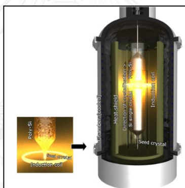
รูปที่ 2. 2 ขั้นตอนการผลิตซิลิกอนเวเฟอร์ด้วยวิธี Float Zone (FZ)
