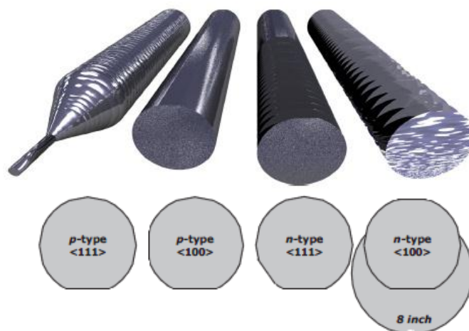
รูปที่ 2. 3 ขั้นตอนการผลิตซิลิกอนเวเฟอร์ด้วยวิธี Float Zone (FZ)
