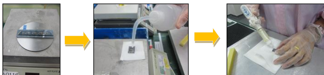
รูปที่ 3. 14 ขั้นตอนการแยกชิ้นงานหลังจากการตัดงานด้วยเครื่องตัด (Dicing Machine)
