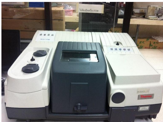
รูปที่ 3. 2 เครื่องฟูเรียร์ทรานสฟอร์มอินฟราเรดสเปกโตรมิเตอร์ ของ Thermo scientific รุ่น Nicolet 6700
