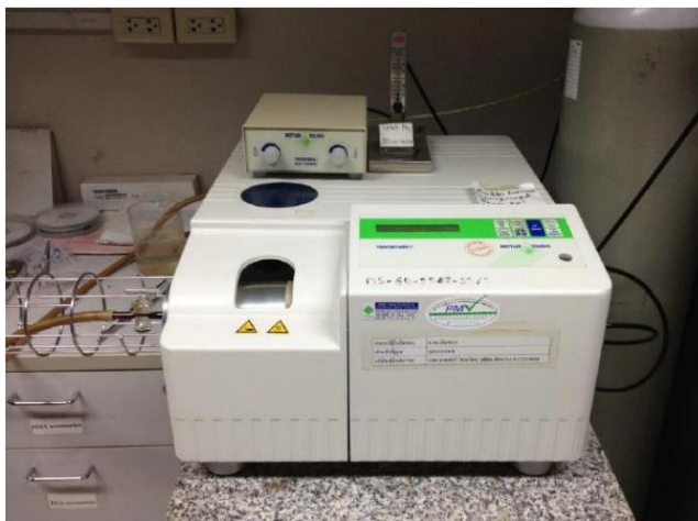
รูปที่ 3. 9 เครื่องวิเคราะห์น้ำหนักภายใต้ความร้อน ของ Mettler Toledo รุ่น TGA/SDTA851
