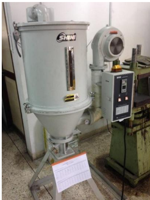
รูปที่ 3. 3 ตู้อบ ของ SHINI ® plastic technologies รุ่น SHD-100T
