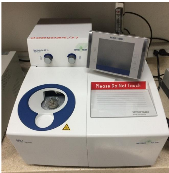
รูปที่ 3. 10 เครื่องดีฟเฟอเรนเชียลสแกนนิ่งแคลอริมิเตอร์ของ Mettler Toledo รุ่น DSC 1 STAR e System
