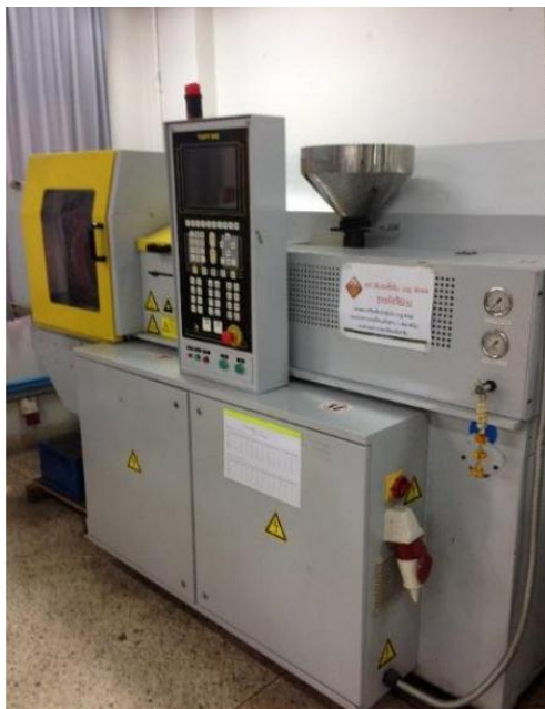
รูปที่ 3. 4 เครื่องฉีดพลาสติกของ Topfine Precision Machinery รุ่น A25
