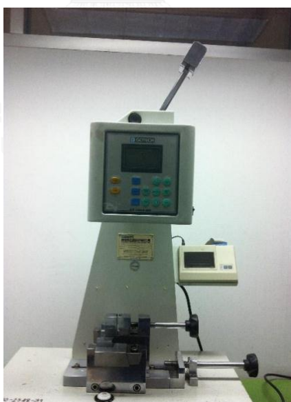
รูปที่ 3. 8 เครื่องทดสอบความทนแรงกระแทก ของ GOTECH รุ่น GT-7045-MD
