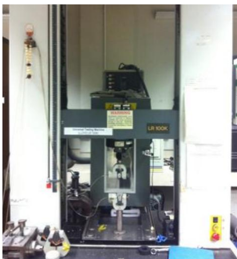
รูปที่ 3. 6 เครื่องทดสอบอเนกประสงค์ ของ LLOYD รุ่น LR100K
