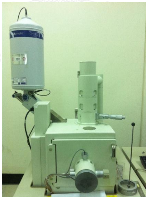
รูปที่ 3. 5 กล้องจุลทรรศน์อิเล็กตรอนแบบส่องกราด ของ JEOL รุ่น JSM-6480LV
