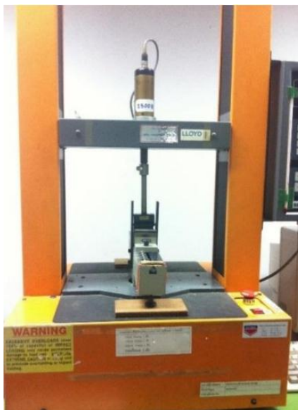
รูปที่ 3. 7 เครื่องทดสอบเนกประสงค์ ของ LLOYD รุ่น LR500
