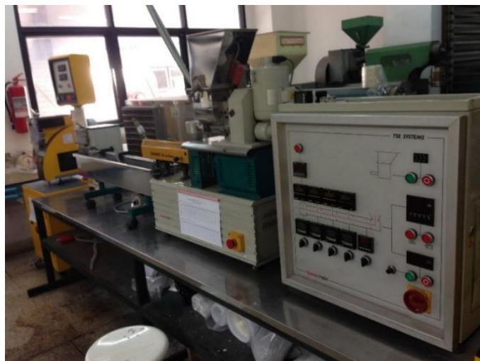
รูปที่ 3. 1 เครื่องอัดรีดสกรูคู่ของ Thermo Prism รุ่น DSR-28
