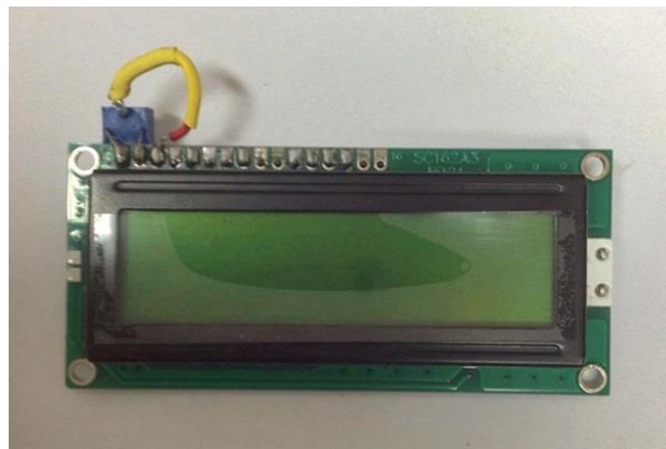
รูปที่ 4.13 ภาพจอ LCD ขนาด 16 ตัวอักษร จำนวน 2 บรรทัด
