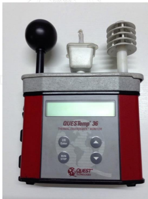
รูปที่ 3.17 เครื่องวัดอุณหภูมิเวทบัลบ์โกลบ Wet Bulb Globe Temperature Meter
