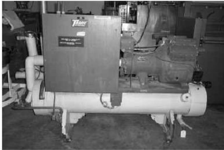
จุฬาลงกรณ์มหาวิทยาลัย www.jnu.ac.th UNIVERSITY ภาพที่ 2.4 เครื่องทำน้ำเย็นแบบระบายความร้อนด้วยน้ำ
