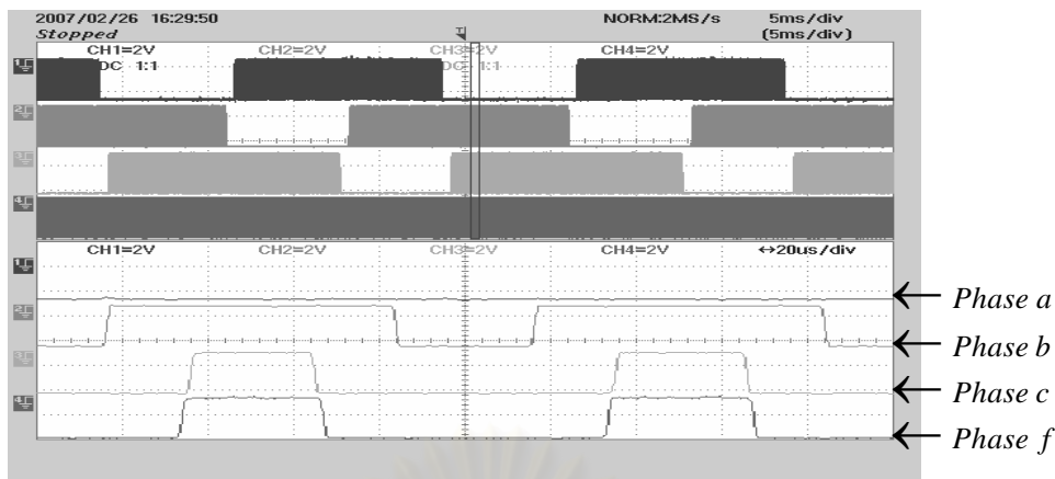
รูปที่ 4.54 ค่าแรงดันควบคุมสวิตช์ตัวบนของสวิตช์ทั้ง 4 กิ่ง ( v_{fn} = -\frac{1}{2}(2v_{\min} + V_g) )
