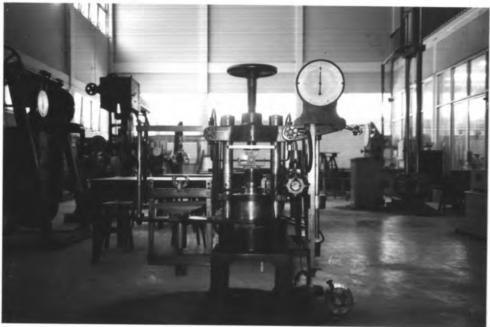
รูปที่ 4.2 เครื่องมือทดสอบกำลังรับแรงอัด ( ภาควิชาวิศวกรรมโยธา จุฬาลงกรณ์มหาวิทยาลัย )
