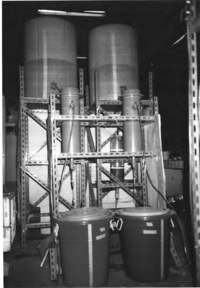
รูปที่ 4.6 อุปกรณ์ทดสอบการชะละลายของโลหะหนัก
