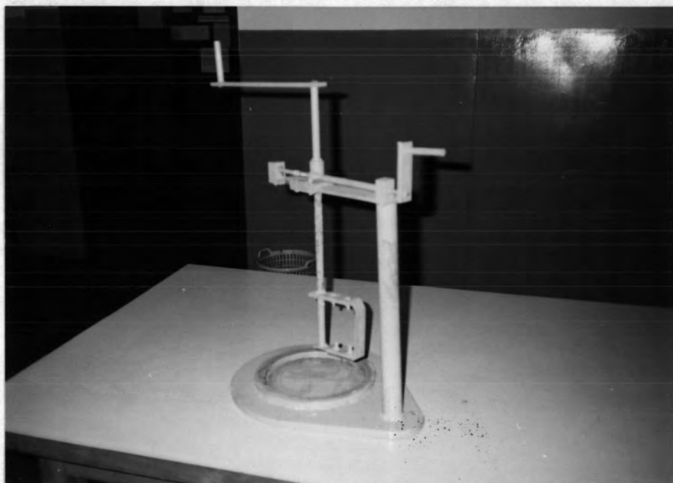
รูปที่ 7.16 เครื่องควั่นห้องเผาไหม้เตาฯ
