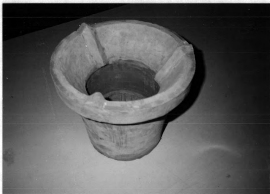
รูปที่ 7.17 เตาหุงต้มประสิทธิภาพสูงจากการอัด
