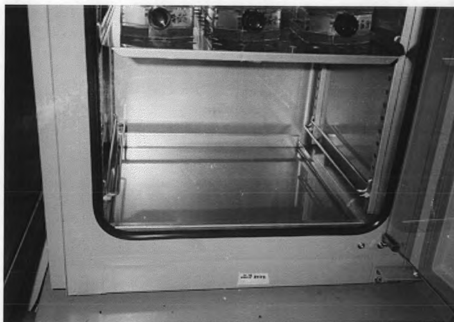
รูปที่ 6 Humidity Pan ของตู้บดด้วยก๊าซคาร์บอนไดออกไซด์
