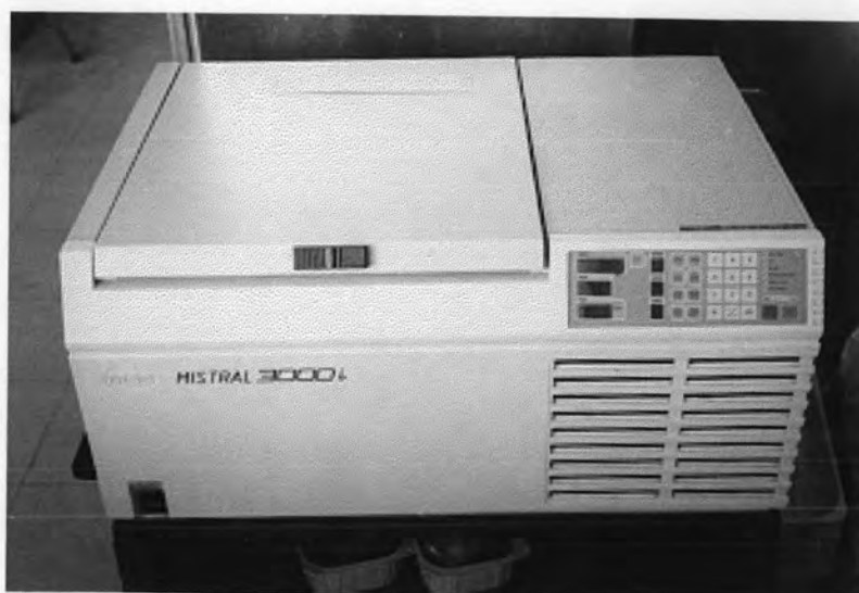
รูปที่ 9 เครื่องปั่นแยกส่วนประกอบของโลหิต Mistral 3000i
