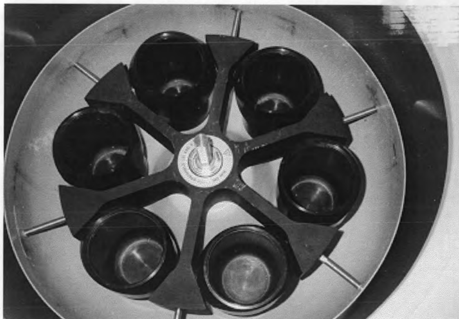
รูปที่ 8 ชุดโรเตอร์ของเครื่องปั่นแยกส่วนประกอบของโลหิต Mistral 6000
