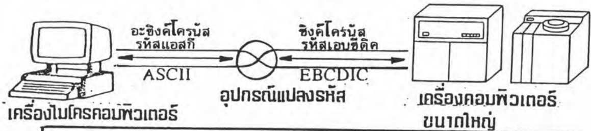
รูปที่ 5.2 การใช้อุปกรณ์แปลงรหัสข้อมูลเป็นอุปกรณ์พิเศษสำหรับการต่อห่วงอุปกรณ์ที่แตกต่างกัน
