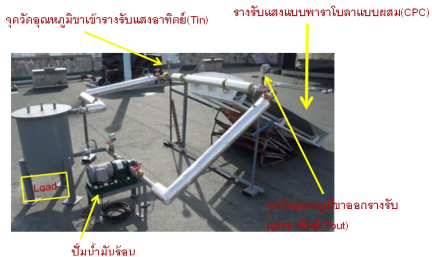
รูปที่ 3.18 แสดงระบบที่ต่อใช้งานจริง ตามแผนผัง
