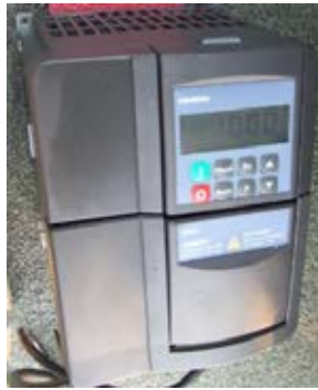
รูปที่ 3.26 Variable Frequency Drive (VFD) ยี่ห้อ SIEMENS รุ่น SED2
