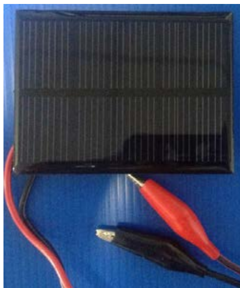
รูปที่ 4.8 แสดงการต่อสายไฟจากแผงโซลาร์เซลล์เพื่อใช้วัดค่ากระแสและแรงดันในการทดลอง
