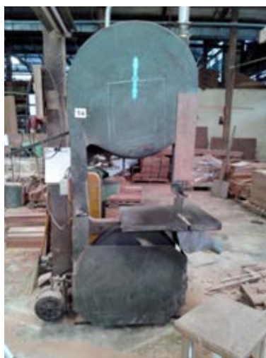
รูปที่ 3.2 เครื่องเลื่อยโค้งที่ปราศจากการ์ดเครื่องจักร
