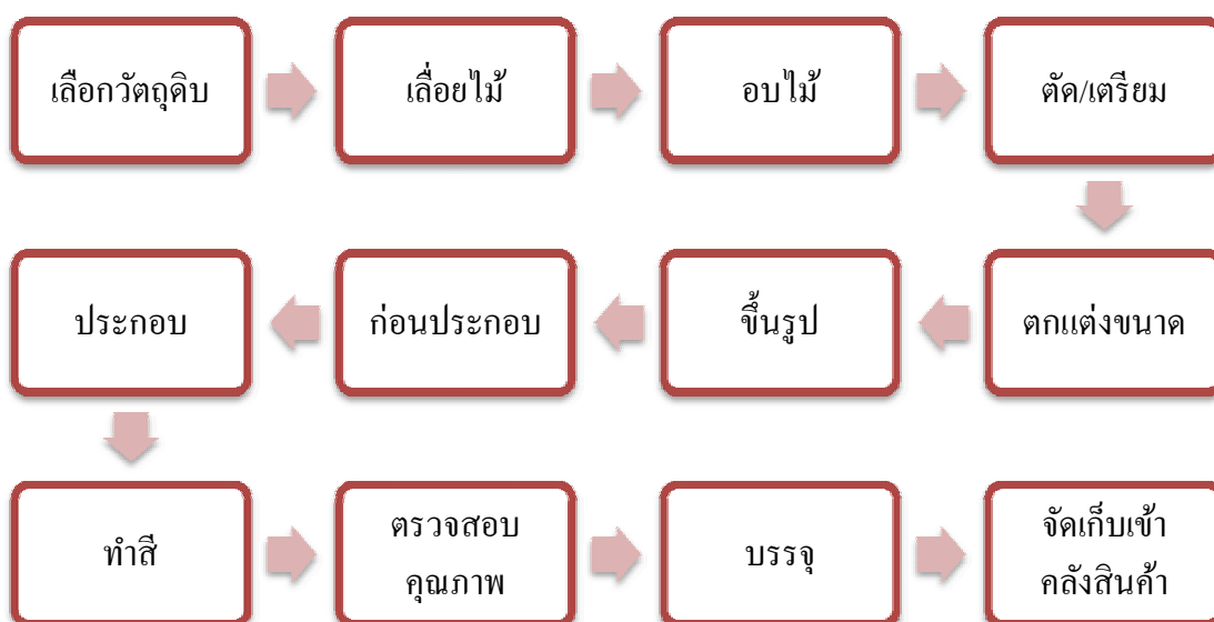
รูปที่ 1.5 กระบวนการผลิตทั่วไปของเฟอร์นิเจอร์ไม้
