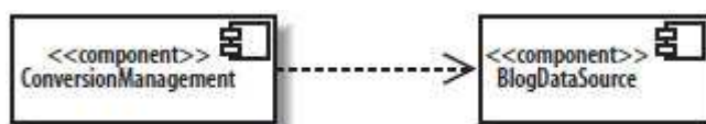
รูปที่ 2.5 ตัวอย่างการนำเสนอสัญลักษณ์ความสัมพันธ์แบบขึ้นต่อกันระหว่างคอมโพเนนท์ [23]
