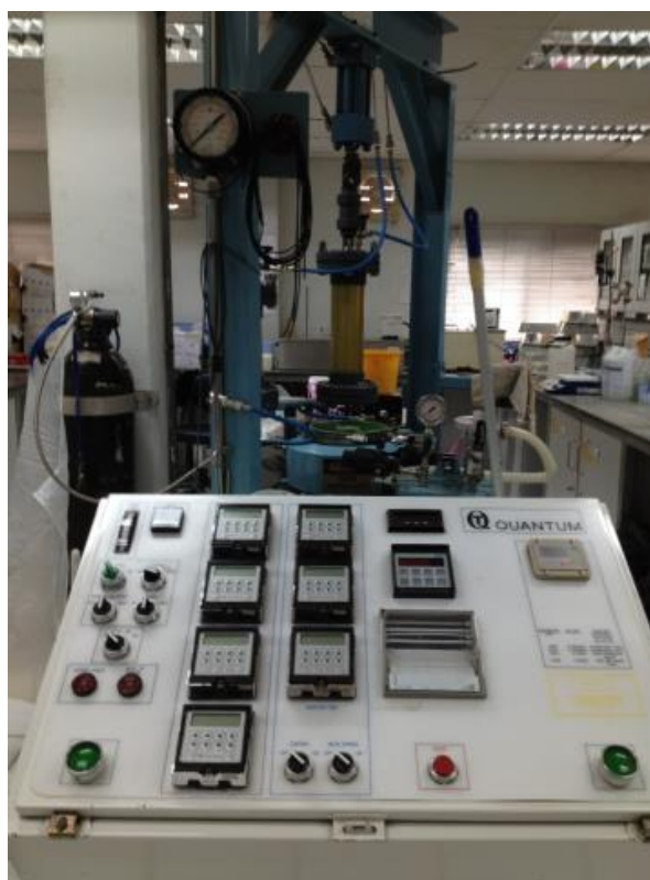
รูปที่ 4.4 เครื่องฟอกเยื่อด้วยออกซิเจนที่ใช้ในห้องปฏิบัติการ
