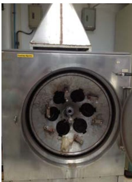
รูปที่ 4.2 หม้อต้มเยื่อจำลองในห้องปฏิบัติการ (Cooking digester)
