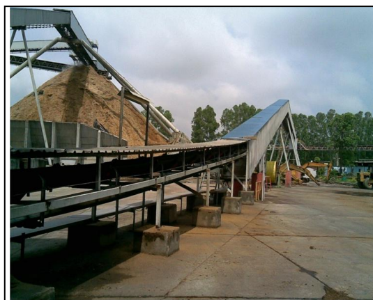
รูปที่ 1.5 สายพานลำเลียงชิ้นไม้สับจากกองชิ้นไม้สับ (Storage) ไปสู่กระบวนการผลิตเยื่อกระดาษ
