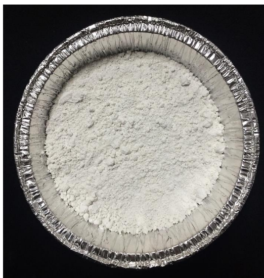
รูปที่ 4.2 ทัลก์ (Talc, Microtuff® AGD) ที่ใช้ในงานวิจัย
