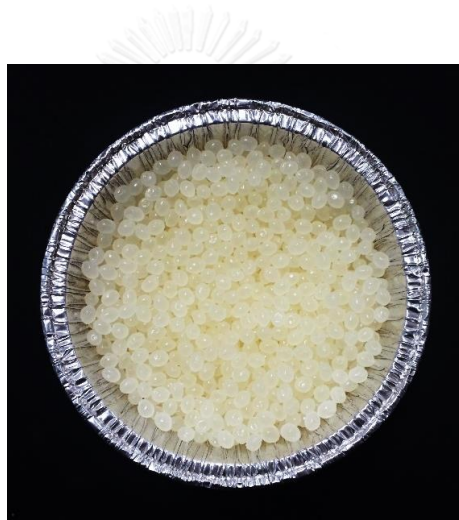
รูปที่ 4.1: เม็ดพลาสติก PLA (Ingeo, 2003D) ที่ใช้ในงานวิจัย
