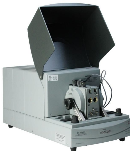
รูปที่ 4.22: เครื่องทดสอบความสามารถในการซึมผ่านของก๊าซออกซิเจน (Mocon OX-TRAN model 2/21, USA)
