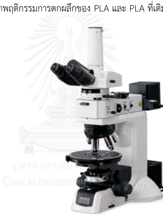
รูปที่ 4.25: กล้องจุลทรรศน์โพลาไรซ์ (Polarized optical microscope, Nikon LV100POL)
