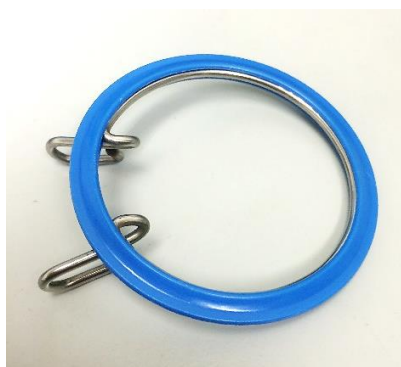
รูปที่ 4.17: ลักษณะวงแหวนที่ใช้ในการตั้งชิ้นงานสำหรับทดสอบความเป็นฝ้าหมอก
