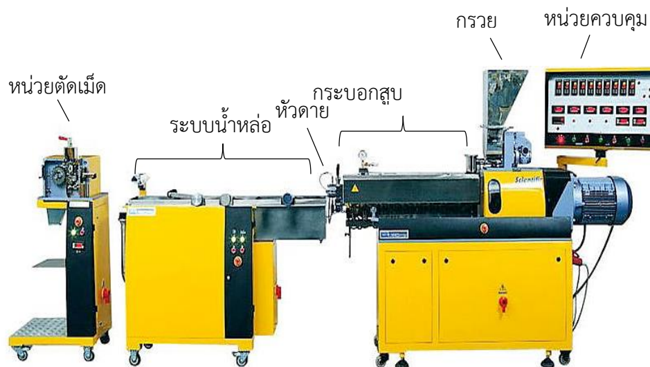
รูปที่ 4.8: เครื่องอัดรีดสกรูคู่ (Twin screw extruder, Labtech Engineering)
