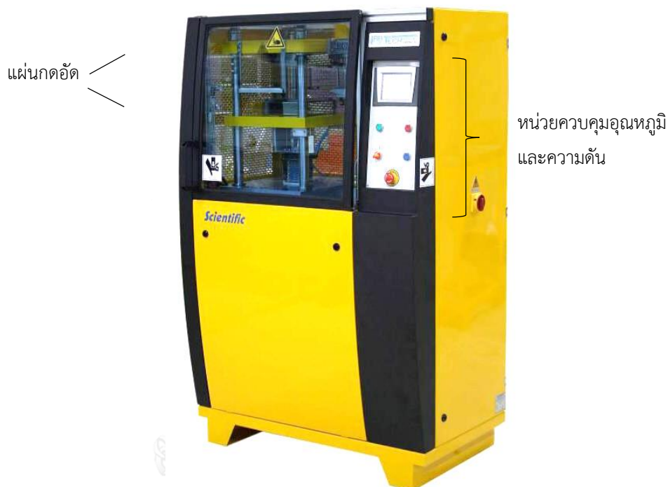
รูปที่ 4.10: เครื่องกดอัด (Hydraulic press, Scientific LP-5-50)
