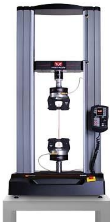
รูปที่ 4.13: เครื่องทดสอบสมบัติเชิงกล (Universal testing machine, Instron model 5567)
