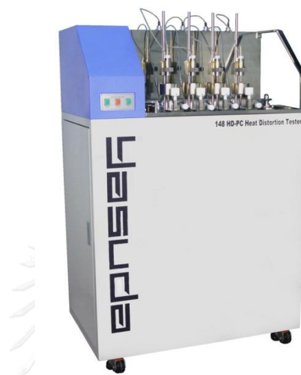
รูปที่ 4.12: เครื่อง Heat distortion tester (YASUDA SEIKI, 148 HD-PC)
