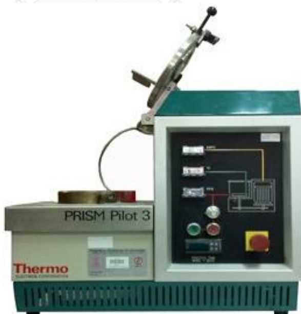
รูปที่ 4.7: เครื่องผสมความเร็วสูง (High speed mixer)
