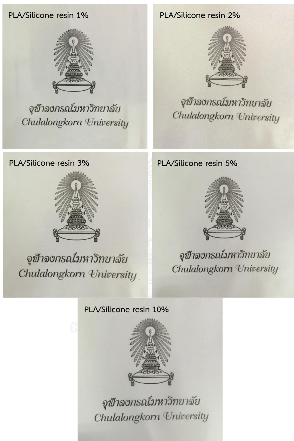
รูปที่ 5.36 ลักษณะปรากฏของฟิล์ม PLA และ PLA ที่เติมสารเพิ่มความยืดหยุ่น (ก) ยางซิลิโคน (ข) เรซินซิลิโคน (ค) ยางผสม SAR ร้อยละ 1 2 3 5 และ 10 โดยน้ำหนัก
