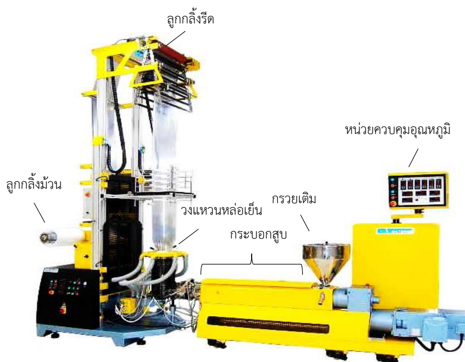
รูปที่ 4.9: เครื่องเป่าฟิล์ม (Collin, Blown film line BL 180/400E)
