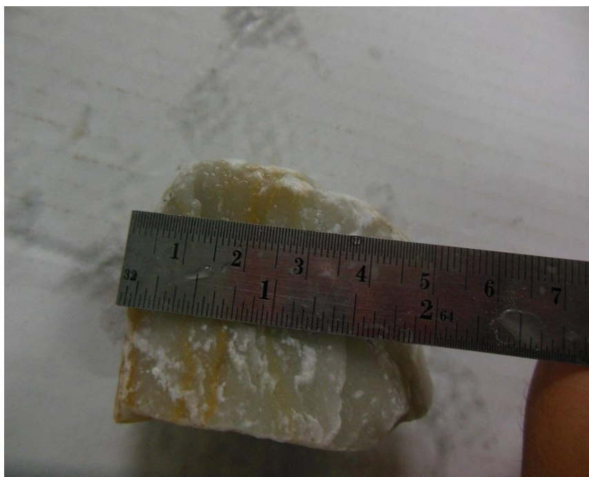
รูปที่4.1แสดงภาพถ่ายหินปูนขนาด 2 นิ้ว ที่ใช้ทำการทดลอง
