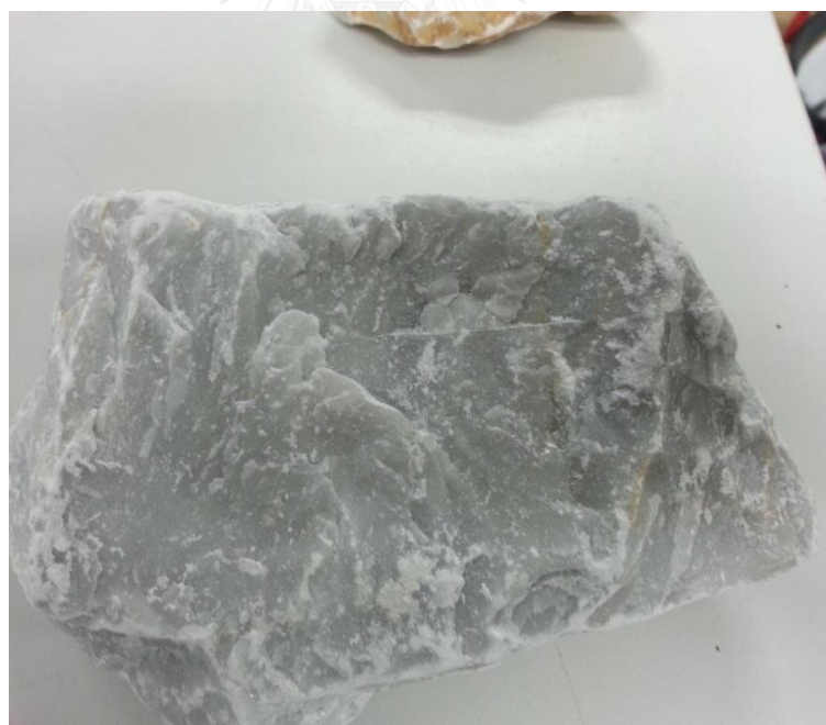
รูปที่4.4 แสดงภาพถ่ายหินปูนขนาด 5 นิ้ว ที่ใช้ทำการทดลอง
