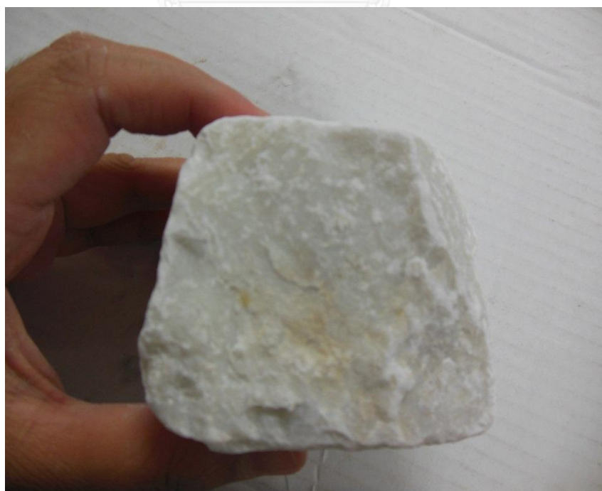
รูปที่4.2แสดงภาพถ่ายหินปูนขนาด 3 นิ้ว ที่ใช้ทำการทดลอง
