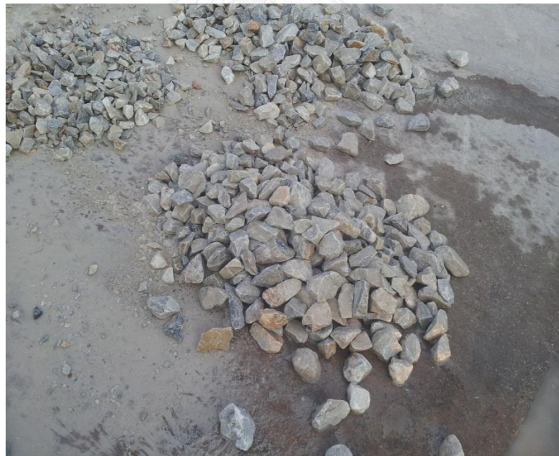
รูปที่4.6 แสดงภาพถ่ายการสุมหินปูนอุตสาหกรรมจากกองเพื่อทำการทดลอง
