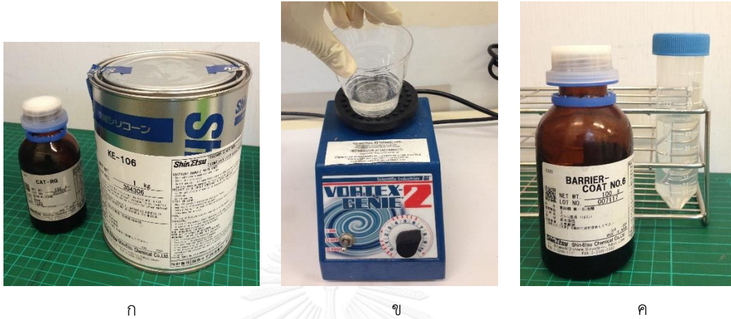
รูปที่ ๒2 ภาพถ่าย (ก) สารเร่งปฏิกิริยากับ PDMS (ข) การผสมสารละลาย PDMS และ (ค) สารเคลือบผิวและสารละลายของสารเคลือบผิว
