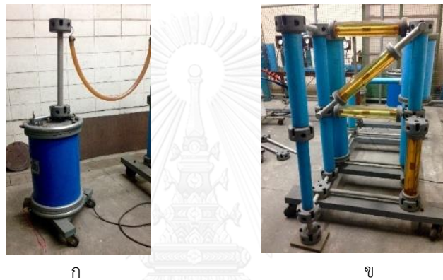
รูปที่ 3.9 ภาพถ่าย (ก) หม้อแปลงทดลองและ (ข) วงจรเรียงกระแสตรง
