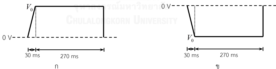
รูปที่ 3.10 รูปคลื่นแรงดันไฟฟ้า (ก) ขั้วบวกและ (ข) ขั้วลบ
