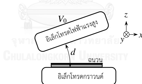
รูปที่ 5.13 ระบบอิเล็กโทรดแบบระนาบเอียงที่มีฉนวนพอลิไอมิดและ PDMS
