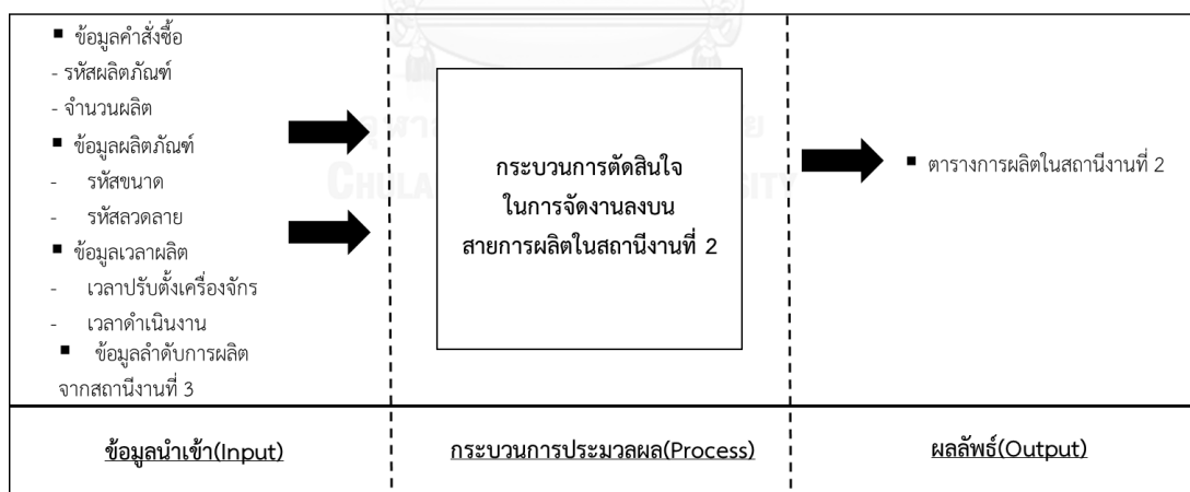
รูปที่ 4.17 กระบวนการตัดสินใจในการจัดงานลงบนสายการผลิตในสถานีนงานที่ 2
