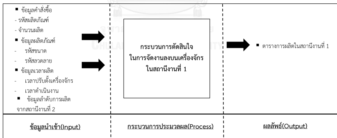
รูปที่ 4.20 กระบวนการตัดสินใจในการจัดงานลงบนเครื่องจักรในสถานีงานที่ 1
