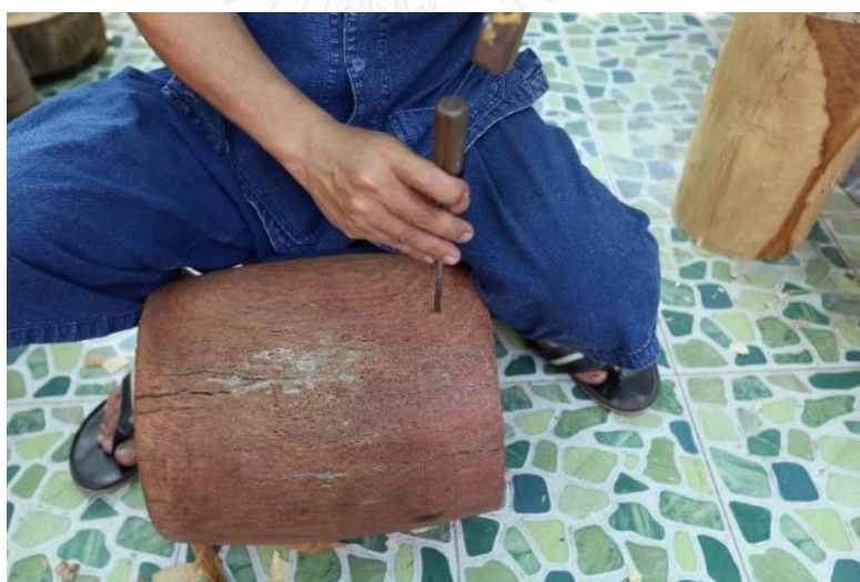
ภาพที่ 58 การใช้วัสดุปลายแหลมกำหนดตำแหน่งรูแซว
