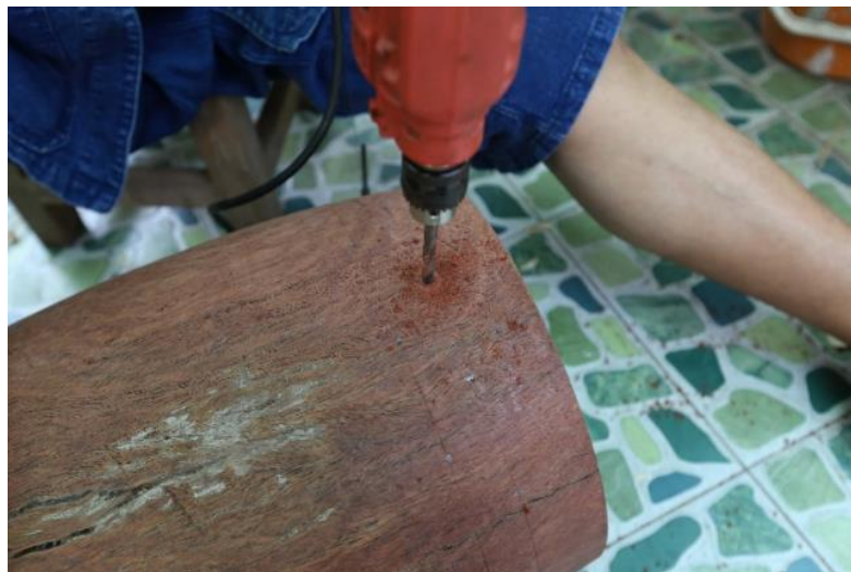
ภาพที่ 59 การใช้สว่านไฟฟ้าเจาะรูแซว
