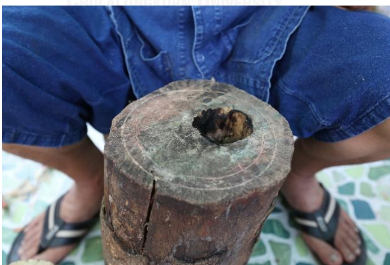
ภาพที่ 49 การกำหนดตำแหน่งขอบกลองด้านนอกและด้านใน
