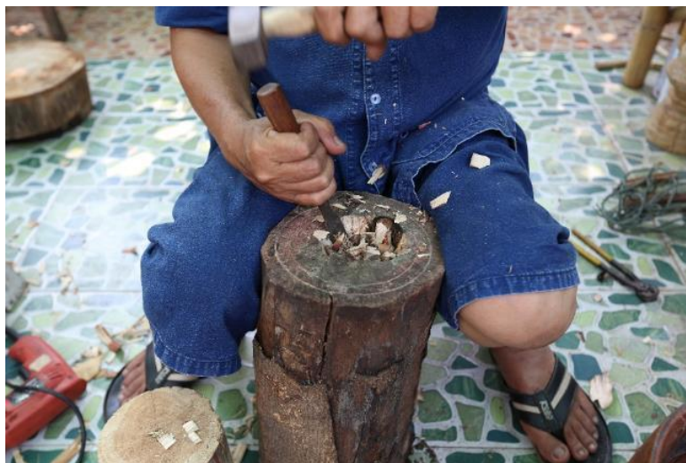
ภาพที่ 50 การชุดกลองด้วยเหล็กเซาะ
