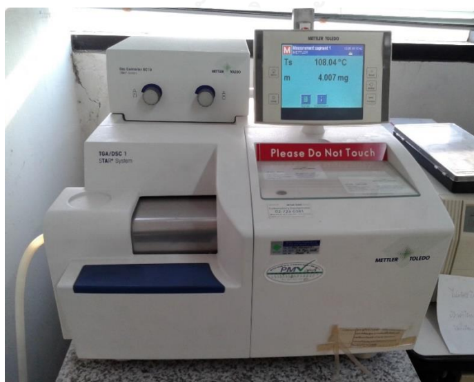
รูปที่ 3.3 เครื่อง METTLER TOLEDO STARe SYSTEM TGA/DSC1 Module
