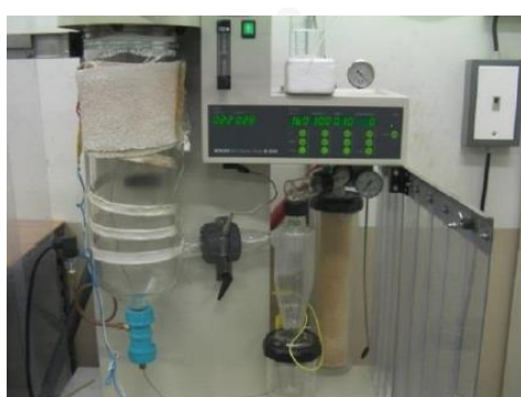
รูปที่ 2.16 เครื่องอบแห้งแบบพ่นฝอยที่ติดตั้งเครื่องทำความร้อนแบบผ้ากับปั๊มสุญญากาศ [30]
