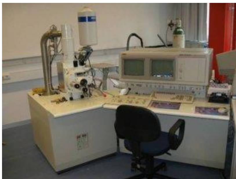
รูปที่ 3.4 เครื่องจุลทรรศน์อิเล็กตรอนแบบส่องกราด
