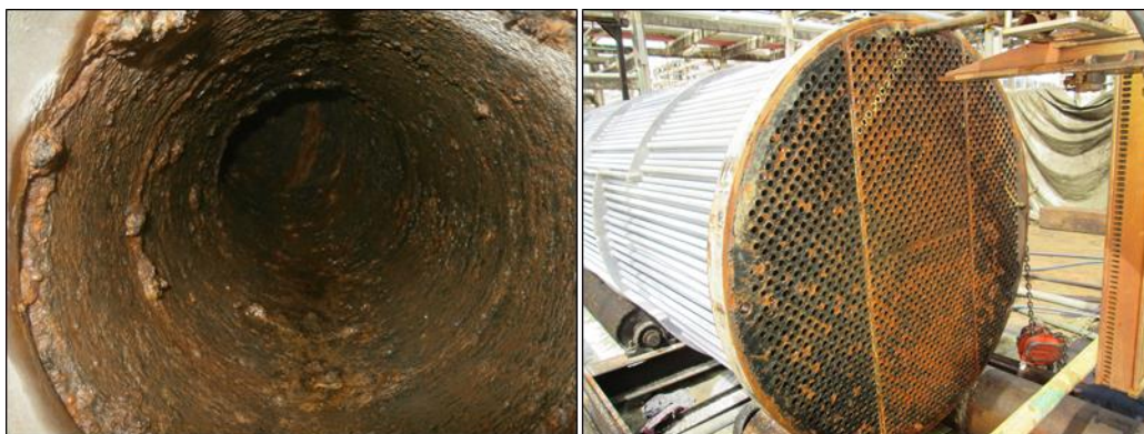
รูปที่ 1.1 ภาพถ่ายการผุกร่อนของท่อและอุปกรณ์แลกเปลี่ยนความร้อนของระบบน้ำหล่อเย็น
