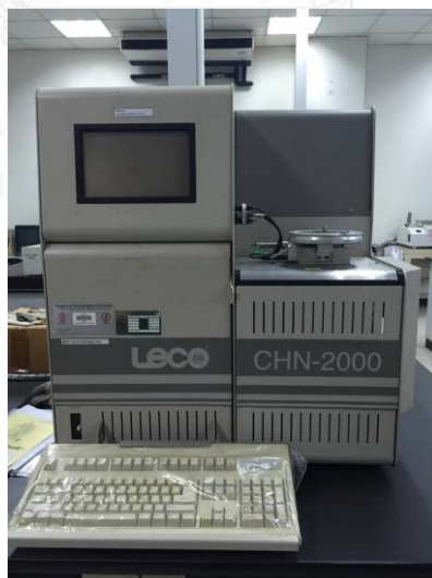
รูปที่ 3.3 เครื่องวิเคราะห์แบบแยกธาตุ (CHN analyzer รุ่น CHN-2000, LECO Instrument (Thailand) Ltd.)
