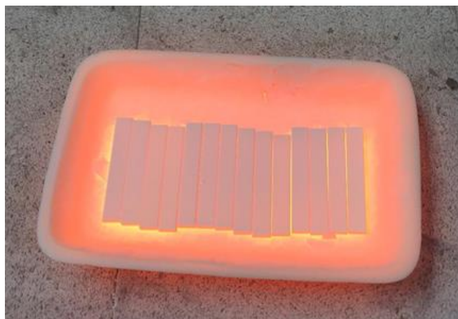
รูปที่ 4.29 ชิ้นงานสูตร CR20:ML80 หลังการทดสอบความต้านทานต่อการเปลี่ยนแปลงอุณหภูมิอย่างฉับพลัน รอบที่ 25
