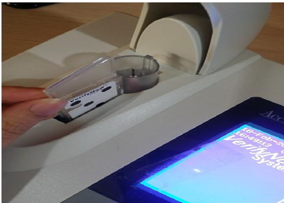
ภาพที่ 10 แสดงวิธีการใส่ reagent device เข้าในเครื่องทดสอบ
