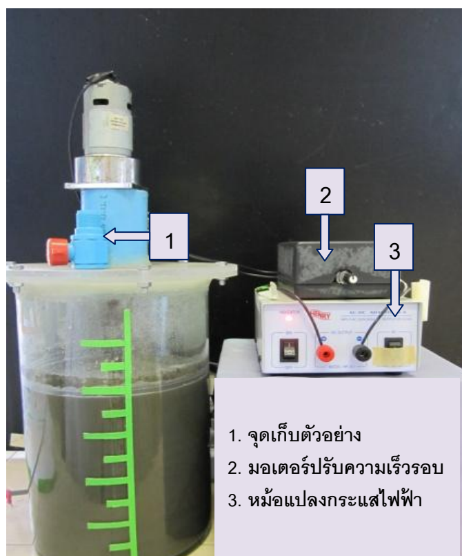
ภาพที่ 3.12 ถังหมักแบบกวนขนาด 5 ลิตร ที่ใช้ในการทดลอง
