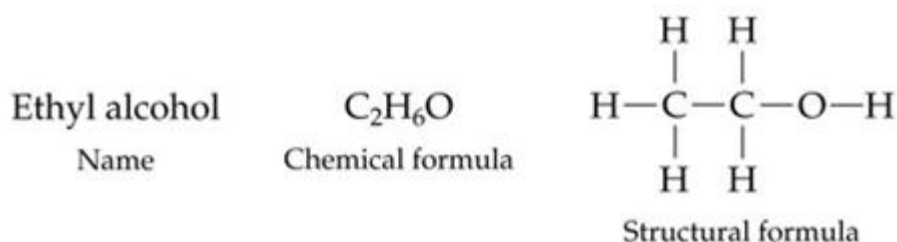
ภาพที่ 2.1 สูตรเคมีและโครงสร้างของเอทานอล
