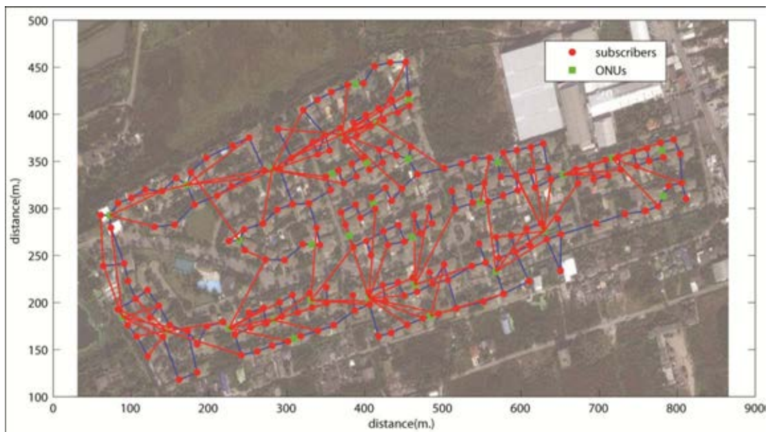
รูปที่ 5.7 ตำแหน่งการวางของ ONU ในกรณีที่ผู้ใช้บริการทุกรายสามารถเชื่อมต่อเข้าสู่ ONU ภายใน 3 hop เมื่อนำไปประยุกต์กับแผนที่จริง
