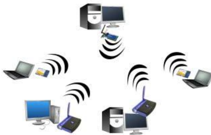
รูปที่ 2.9 การทำงานในโหมด ad-hoc หรือ peer-to-peer mode [25]
