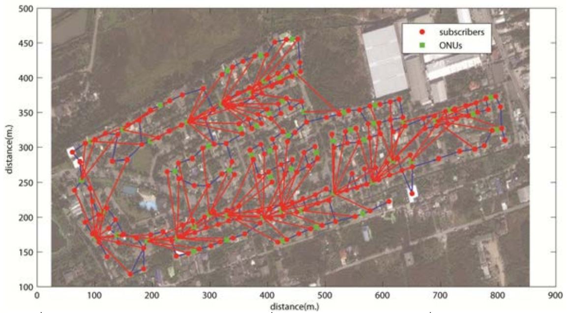
รูปที่ 5.6 ตำแหน่งการวางของ ONU ในกรณีที่ผู้ใช้บริการทุกรายสามารถเชื่อมต่อเข้าสู่ ONU ภายใน 2hop เมื่อนำไปประยุกต์กับแผนที่จริง
