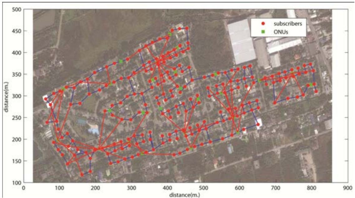
รูปที่ 5.8 ตำแหน่งการวางของ ONU ในกรณีที่ใช้บริการทุกรายสามารถเชื่อมต่อเข้าสู่ ONU
