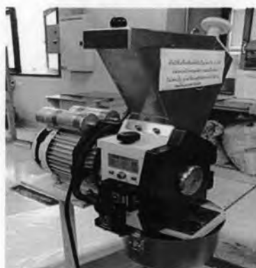
รูปที่ 3.2 เครื่องบดละเอียด ผู้ผลิต FRITSCH รุ่น T15, Markt Einersheim, Germany (ภาควิชาวัสดุศาสตร์)
