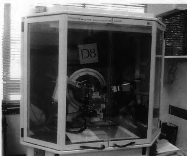
รูปที่ 3.10 X-ray Diffraction (XRD) รุ่น Bruker AXS Model D8 DISCOVER (ศูนย์เครื่องมือวิจัยวิทยาศาสตร์และเทคโนโลยี จุฬาฯ)
