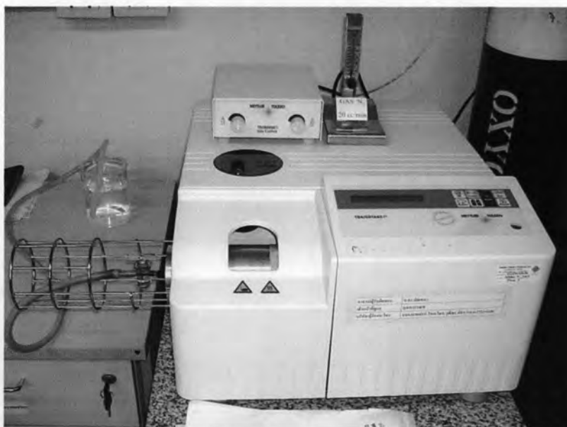
รูปที่ 3.6 เครื่อง TGA ยี่ห้อ Mettler Toledo รุ่น TGA/SDTA 851 o (ภาควิชาวัสดุศาสตร์)
