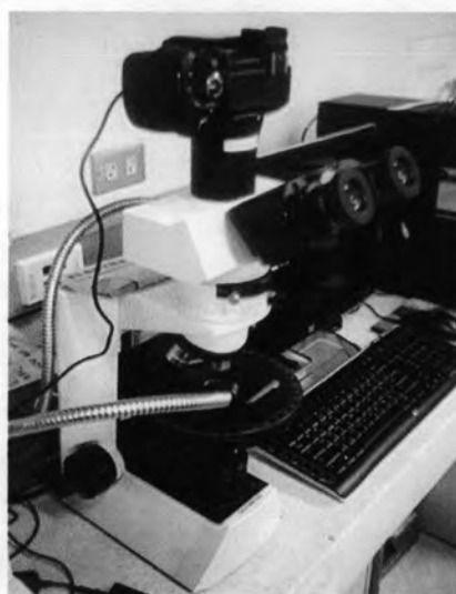
รูปที่ 3.12 กล้องจุลทรรศน์ออปติคัล (Optical Microscope) ของบริษัท OLYMPLUS รุ่น ex-31 (ภาควิชาวัสดุศาสตร์)
