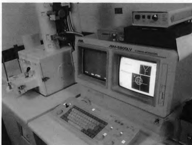
รูปที่ 3.5 กล้องจุลทรรศน์อิเล็กตรอนแบบส่องกราด JEOL รุ่น JSM-5800LV (ศูนย์เครื่องมือวิจัยวิทยาศาสตร์และเทคโนโลยี จุฬาฯ)
