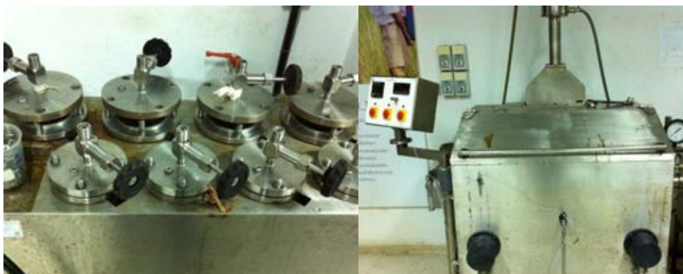
ภาพที่ 3-11 บอมบ์สำหรับบรรจุกากมันสำปะหลังและเครื่องต้มเยื่อ
