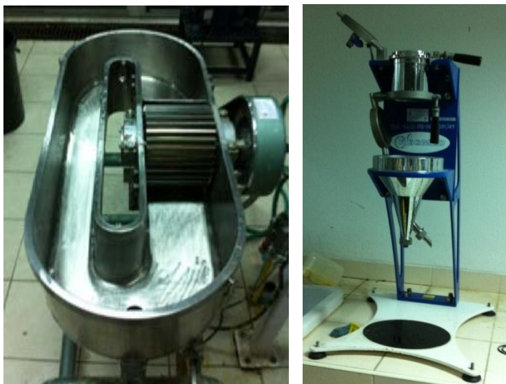
ภาพที่ 3- 1 เครื่องบดเยื่อ (Valley beater) ภาพที่ 3- 2 เครื่องวัดค่าสภาพระบายได้
