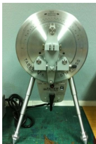
ภาพที่ 3- 13 เครื่องทดสอบความแข็งแรงของกระดาษต่อการโค้ง
