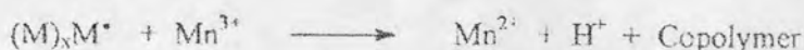
รูปที่ 2.8 กลไกการกราฟต์โดยการริเริ่มด้วยแมงกานีสไฮดรอกไซด์ [15]
