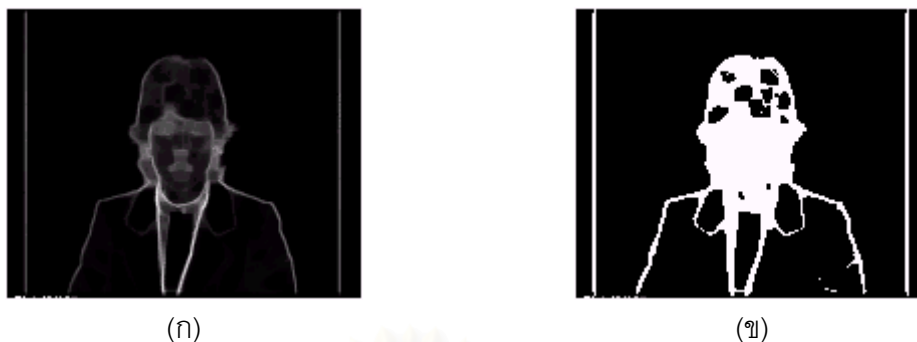
รูปที่ 4.4 แสดงการประมาณเกรเดียนต์แบบหลายชั้นของภาพ Claire
