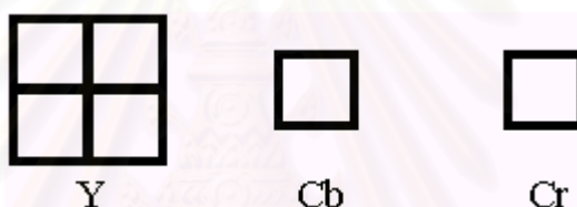
รูปที่ 2.1 โครงสร้างของสัญญาณภาพในรูปแบบอัตราสุ่ม 4:2:0
