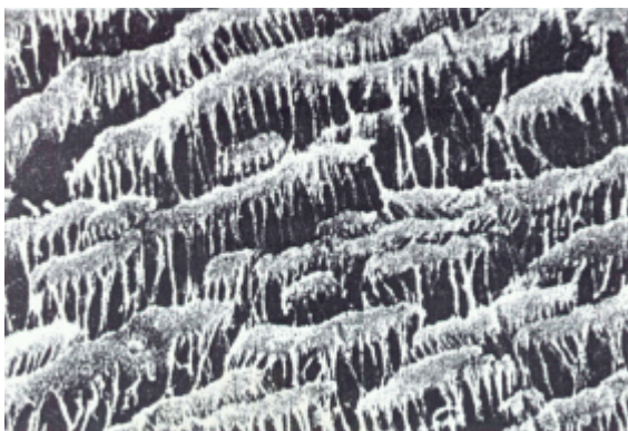
รูปที่ 2-7 แสดงรูพรุนจุลภาคของตัวกรองชนิดแผ่นบางที่ทำจาก PTFE
