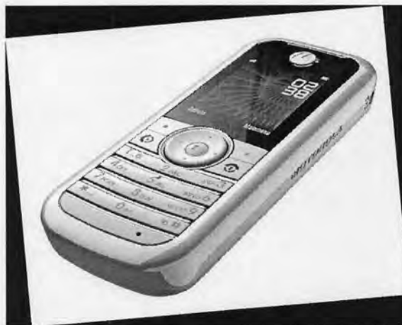
ภาพที่ 16: ภาพแสดงโทรศัพท์ต้นแบบ ผลิตจากวัสดุรีไซเคิล
