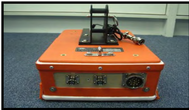
รูปที่ 3.11 ภาพถ่ายเครื่องมือตัวรับและส่งสัญญาณของการสำรวจธรณีฟิสิกส์ด้วยเรดาร์
