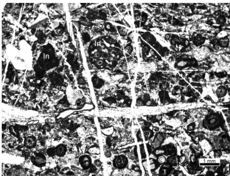
รูป 2.72 หิน Packstone ของตัวอย่าง PAI 38 ที่ประกอบด้วยเม็ดตะกอนประมาณ 75% ที่ถูกเชื่อมประสานด้วยแร่แคลไซต์และตะกอนเนื้อโคลน โดยส่วนใหญ่ประกอบด้วยเม็ดตะกอนที่ Ooid ขนาดประมาณ 0.8 mm มีพวก Intraclast หลากหลายประเภทขนาดประมาณ 1 mm
