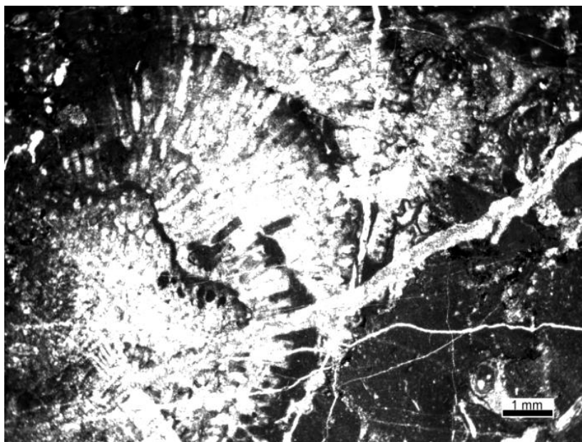
รูป 2.61 หิน Boundstone ของตัวอย่าง CPR 11 ที่มีเม็ดตะกอนของสิ่งมีชีวิตเป็นส่วนใหญ่ของเนื้อหินที่เป็นพวก प्रकारังที่แสดงให้เห็นถึงกาอยู่ร่วมกันของสิ่งมีชีวิตในทะเล มีเมทริกซ์เป็นตะกอนเนื้อโคลนเนียนสีดำ มีสายแร่แคลไซต์ตัดผ่านค่อนข้างหลายสาย
