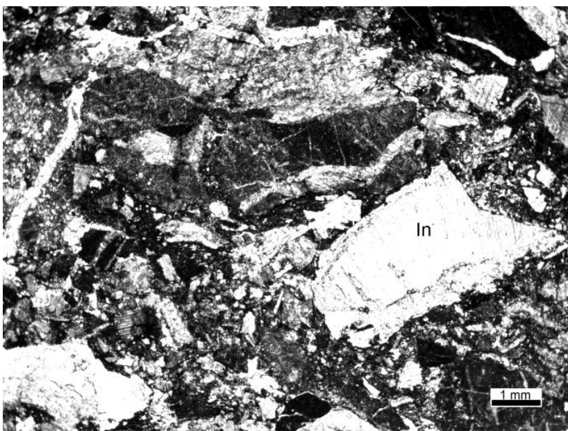
รูป 2.82 หิน Packstone ของตัวอย่าง DLC 33 ที่เป็นเม็ดตะกอนประมาณ 80% ส่วนใหญ่เป็นพวกintraclast(In) โดยขนาดของเม็ดแร่อยู่ที่ประมาณ 1-3 mm มีลักษณะรูปทรงที่เป็น Irregular อาจเกิดจากการถูกพัดพามาจากที่อื่นแล้วมาสะสมตัวใหม่อีกรอบ
