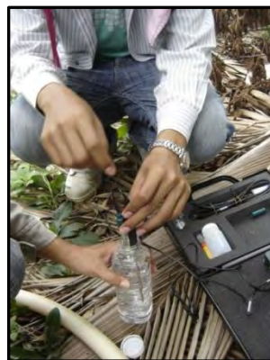
รูปที่ 2.4 แสดงการวัดค่า (pH) และค่าความสามารถในการนำไฟฟ้า (electric conductivity, EC)
