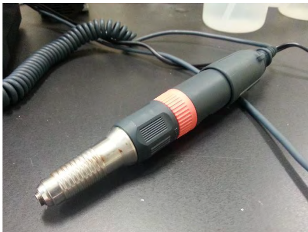
รูปที่ 1.9 ปากกาสว่านเก็บตัวอย่างโดยจะมีหัวเจาะเพชรบริเวณด้านปลายปากกา
