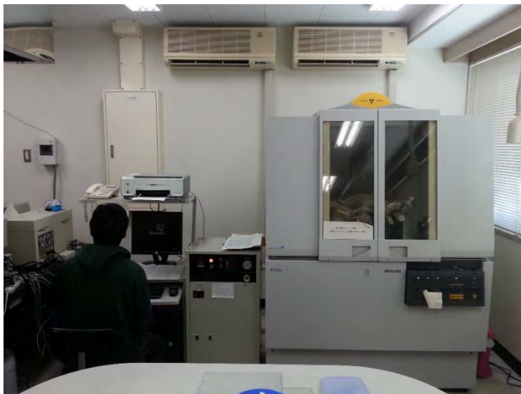
รูปที่ 1.6 เครื่องวิเคราะห์ x-ray diffraction PHILIPS X'Pert
