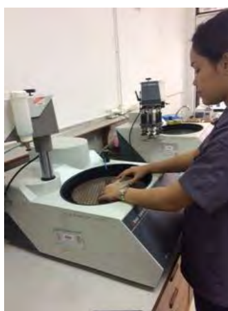
รูปที่ 7 : การนำตัวอย่าง KPC-01-1 ไปขัดมัน (Polishing)
