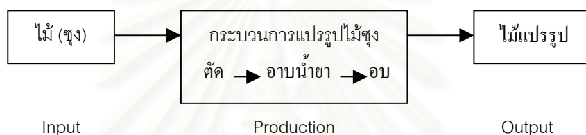
รูปที่ 2.2 แสดงขั้นตอนการผลิตไม้แปรรูป
