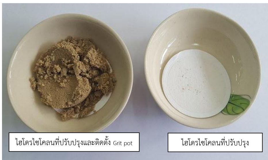
รูปที่ 4- 20 ปริมาณของอนุภาคที่แยกได้จากทางออกด้านล่างระหว่างไฮโดรไซโคลอนที่ได้รับการปรับปรุงโดยการเพิ่มระยะทางออกด้านบน (Vortex finder) และไฮโดรไซโคลอนที่ได้รับการปรับปรุงโดยการเพิ่มระยะทางออกด้านบน และติดตั้ง Grit pot
