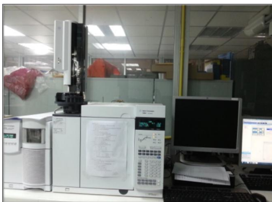
รูปที่ 3.5 เครื่องแก๊สโครมาโทกราฟีประกอบด้วยแมสสเปกโตรมิเตอร์ (Gas Chromatography - Mass Spectrometer, GC-MS)
