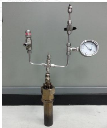
รูปที่ 3.1 เครื่องปฏิกรณ์ขนาดเล็กขนาด 70 มิลลิลิตร (Microreactor)
