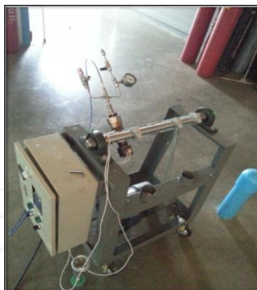
รูปที่ 3.2 ชุดทดลองประกอบด้วยชุดอุปกรณ์ควบคุมอุณหภูมิแบบดิจิทัล หม้อแปลงไฟฟ้าและเครื่องควบคุมเครื่องปฏิกรณ์
