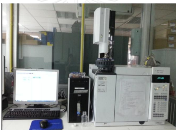
รูปที่ 3.4 เครื่องแก๊สโครมาโทกราฟีแบบจำลองการกลั่น (Simulated Distillation Gas Chromatograph)
