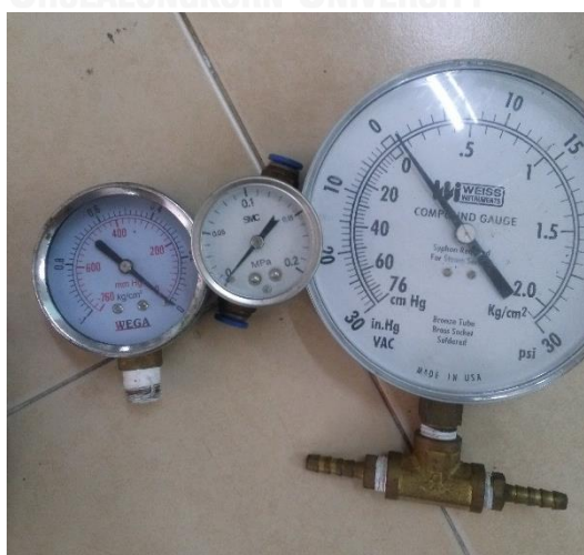
รูปที่ 3. 6 เกจวัดความดัน (Pressure Gauge)
