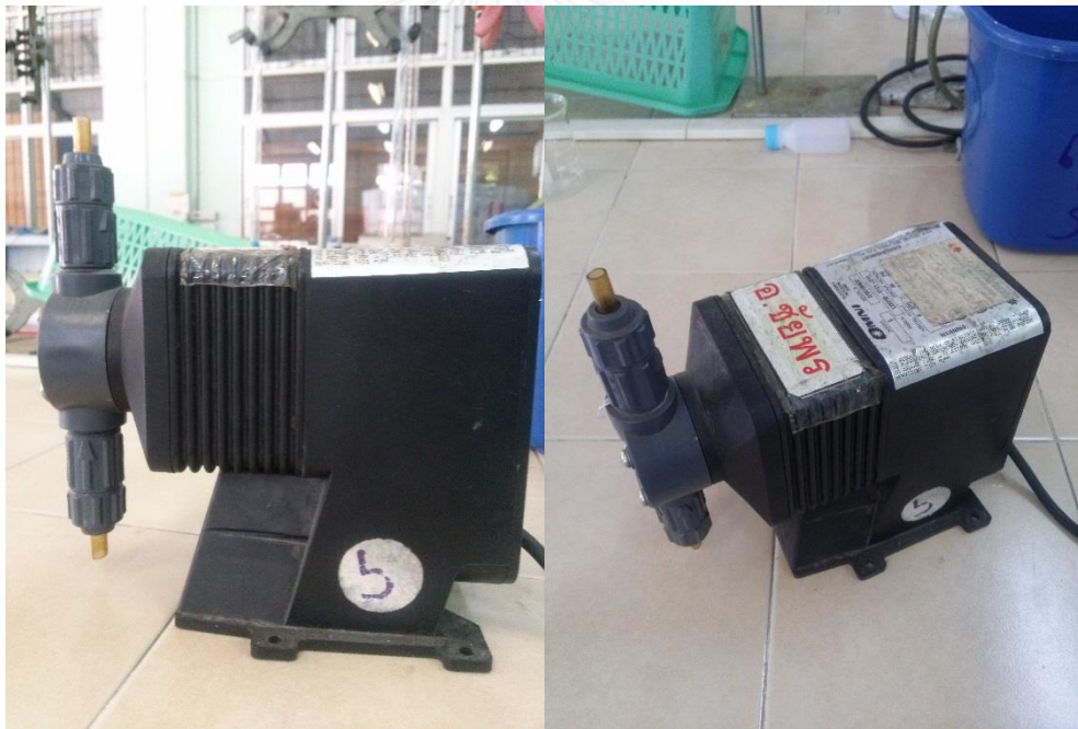
รูปที่ 3. 4 เครื่องสูบน้ำเสียเข้าระบบชนิดไดอะแฟรม (Diaphragm Pump)
