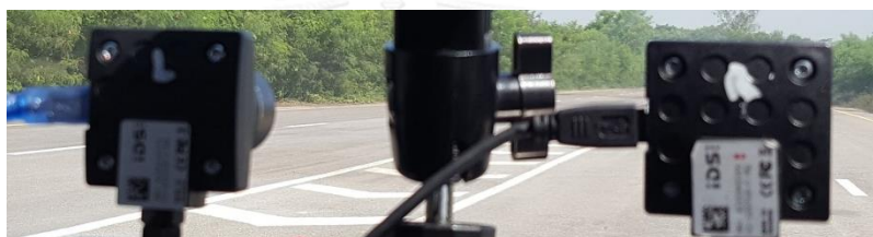
รูปที่ 8 การติดตั้งกล้อง 2 ตัว แบบ Stereo Camera
