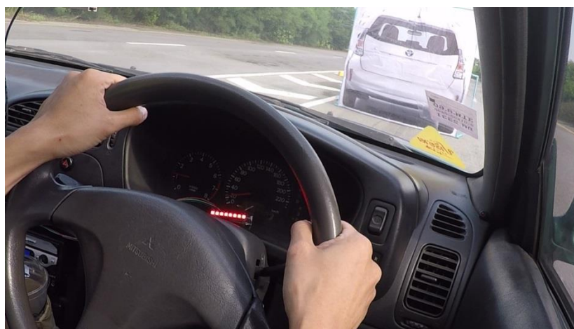
รูปที่ 49 ภาพขณะระบบเตือนการชนด้านหน้าเตือนให้ผู้ขับขี่เบรกเพื่อหลีกเลี่ยงการชนด้วย LED
