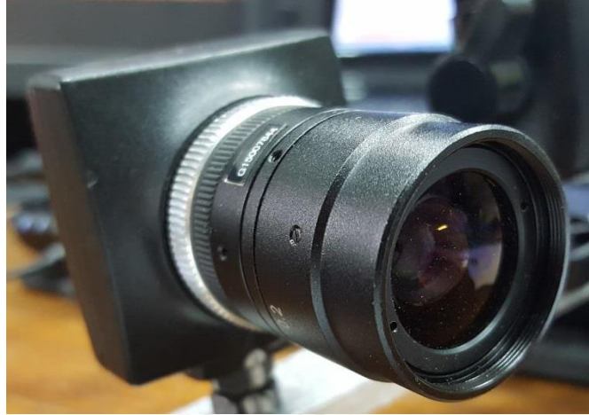
รูปที่ 68 กล้อง IDS 1220LE พร้อมเลนส์ที่มีระยะโฟกัส 8 มิลลิเมตร
