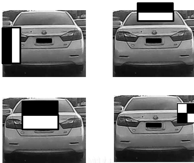
รูปที่ 15 การนำ Haar-like Feature มาใช้ในการตรวจจับรถยนต์
