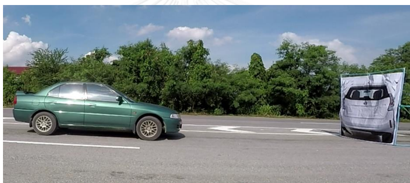
รูปที่ 48 การทดสอบระบบเตือนการชนด้านหน้าด้วยรถยนต์จริง ในสภาวะแวดล้อมแบบปิดขณะที่รถยนต์เคลื่อนที่เข้าใกล้เป้าหมาย
