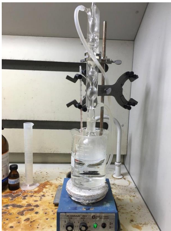
ภาพที่ ข1 สกัดโพลีเมอร์โดยใช้คลอโรฟอร์มเป็นตัวทำละลาย ใช้วิธีการสกัดโดยใช้ชุดสกัดซอก์เลต
