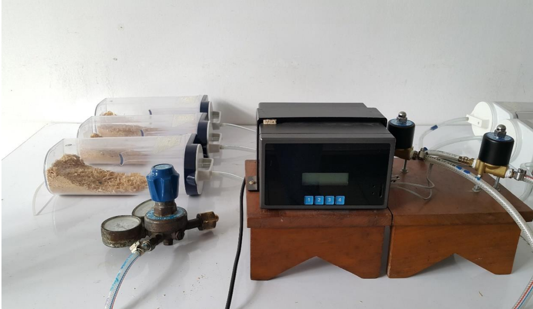
ภาพที่ 2 แสดงเครื่องการตัดจ่ายก๊าซเพื่อจำลองสภาวะ chronic intermittent hypoxia และ อุปกรณ์ที่ใช้ในแบบจำลองทั้งหมดที่อยู่ในกลุ่ม chronic intermittent hypoxia และ normoxia
